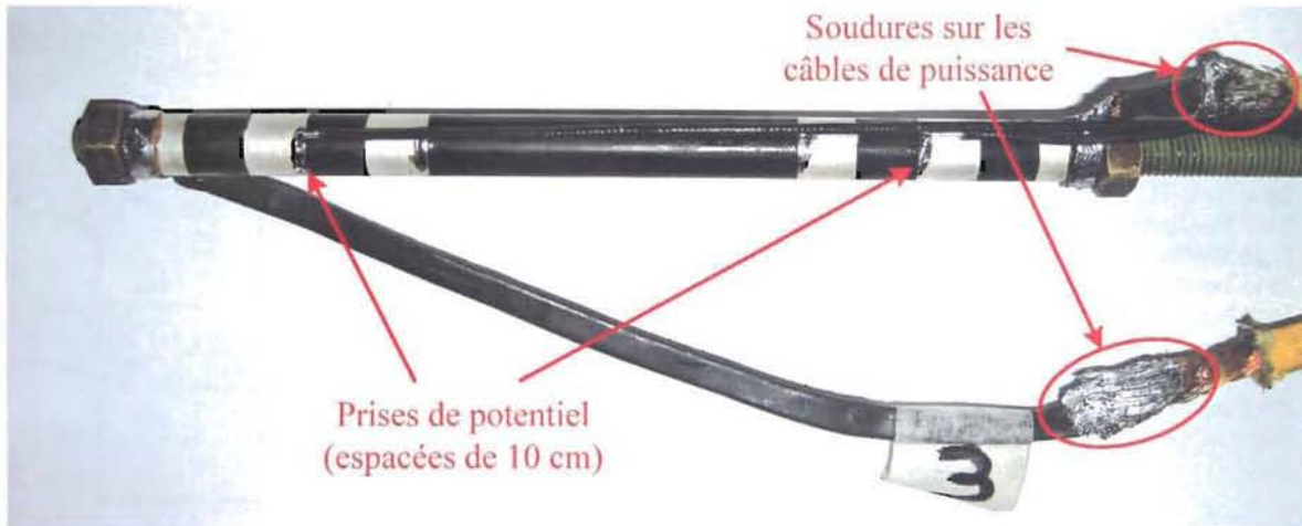
Figure 3.9 : Photo de l'amenee de courant \text{Bi}_{1.8}\text{Pb}_{0.26}\text{Sr}_2\text{Ca}_2\text{Cu}_3\text{O}_{10+x} avec ses prises de potentiel.
