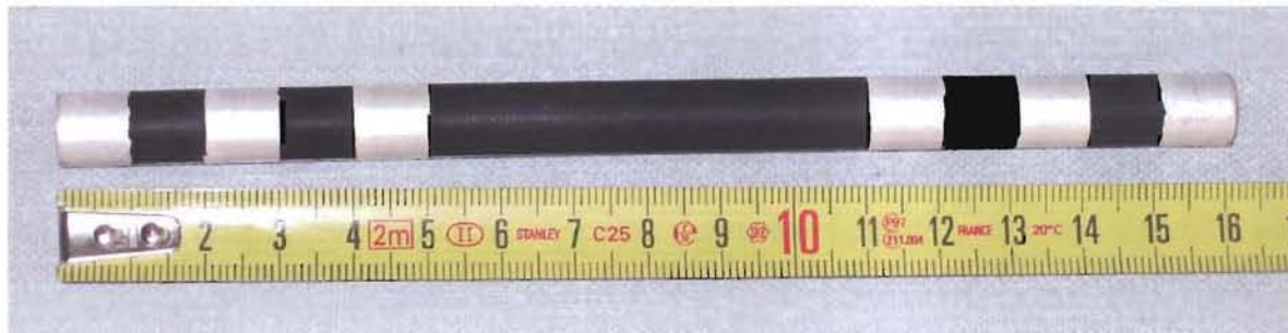
Figure 3.1 : Photo de l'amenée de courant \text{Bi}_{1.8}\text{Pb}_{0.26}\text{Sr}_2\text{Ca}_2\text{Cu}_3\text{O}_{10-x} étudiée.
