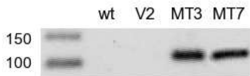
FIG. 6.10 – Amplification sur ADN génomique du gène PiMt1 sur la souche sauvage (wt), le transformant plasmide vide (V2) et les clones MT3 et MT7.
