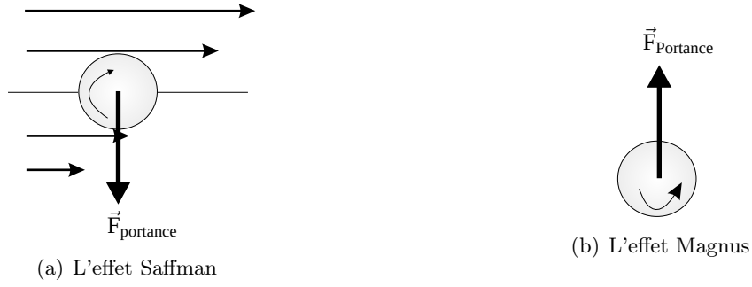
FIG. 1.2 – Les différentes origines de la force de portance
