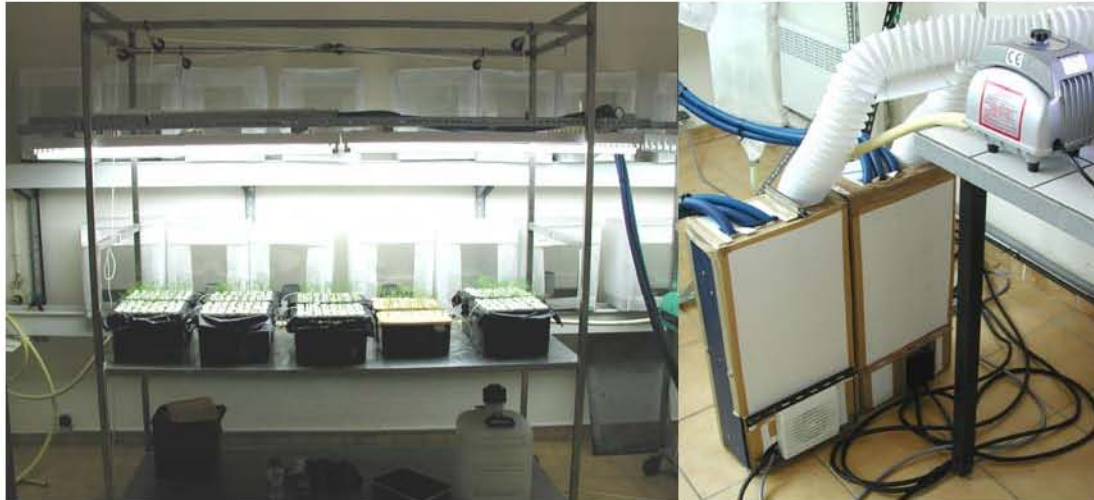
Figure C-7 : Vue générale des tables métalliques équipées de leur système d'éclairage à hauteur réglable et avec déport des ballasts dans des caissons ventilés.
