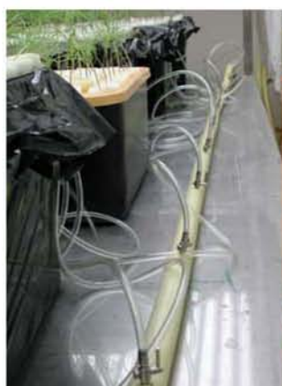
Figure C-5 : Système d'oxygénation de la solution nutritive par injection d'air à travers des diffuseurs pour aquarium.
