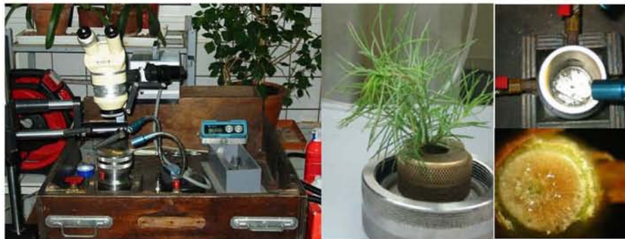
Figure C-14 : Mesure du potentiel de base sur une plantule en utilisant la chambre de Schölander. De gauche à droite, dispositif avec chambre et loupe binoculaire (a), couvercle de la chambre et maintien de la plantule au niveau du collet (b), vue de l'intérieur de la chambre avec les arrivées et sortie d'azote comprimé (c), vue de la tige avec début d'exsudation de la sève sous l'effet de la pression (d).
