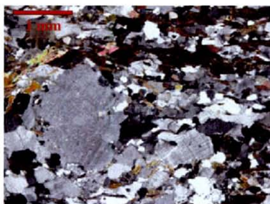
Fig.2.1A - Tipica tessitura di uno gneiss occhiadino (Kfs+Qtz+Pl+Bt \pm Ms) (Typical texture of augen gneiss)
