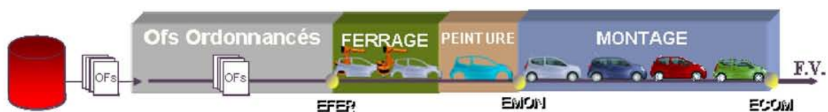
Figure 1-3 : Le flux Véhicule au sein d'une usine terminale
