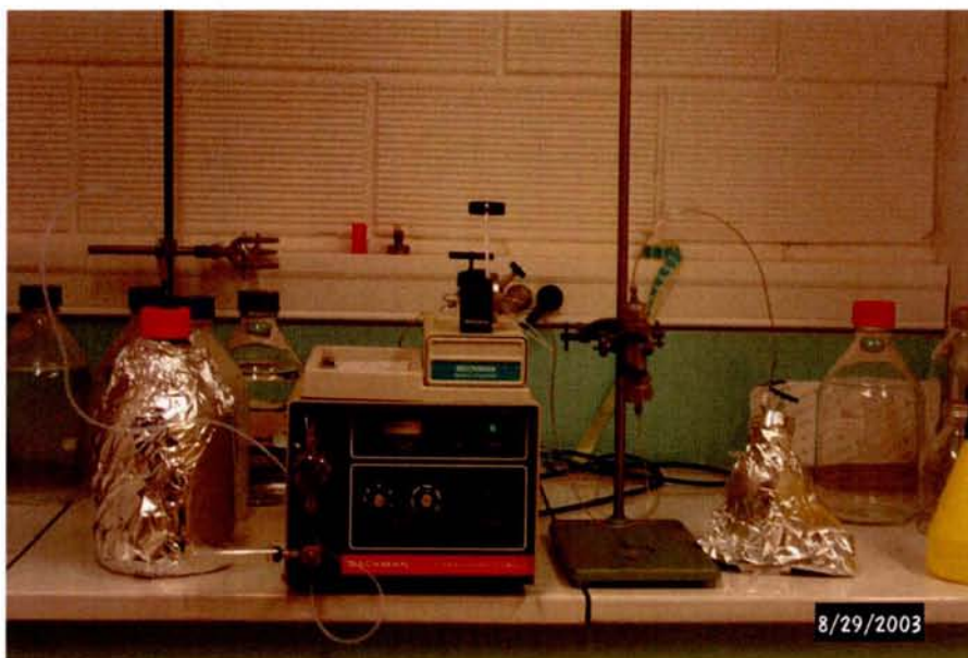
Figure 7. Dispositif expérimental utilisé lors des essais en colonne. De gauche à droite : flacon en verre pour l'alimentation, pompe HPLC, Colonne en acier inoxydable, flacon de récupération en verre.
