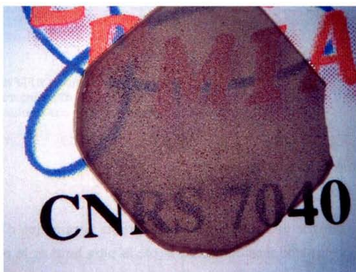
Figure V-15 : Films transparent autosupporté (épaisseur 125 \mu\text{m} ) réalisé au laboratoire LPMIA.
