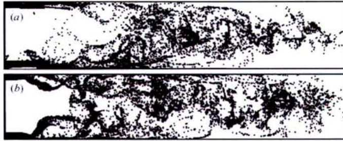
FIG. 7 – Visualisation des bouffées turbulentes (a) “puff” ; (b) “slug” d’après Shan et al. [125]
