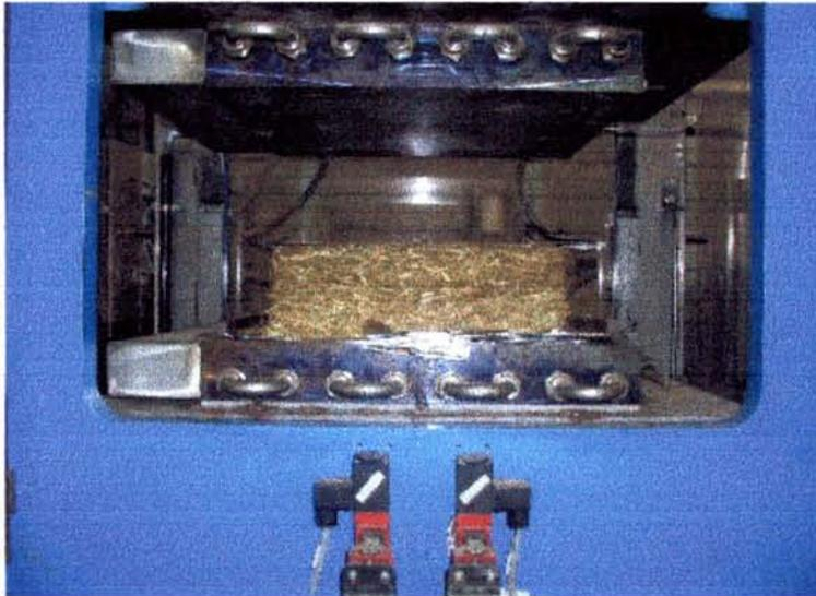
**Figure 40** La presse pour la fabrication de panneaux
