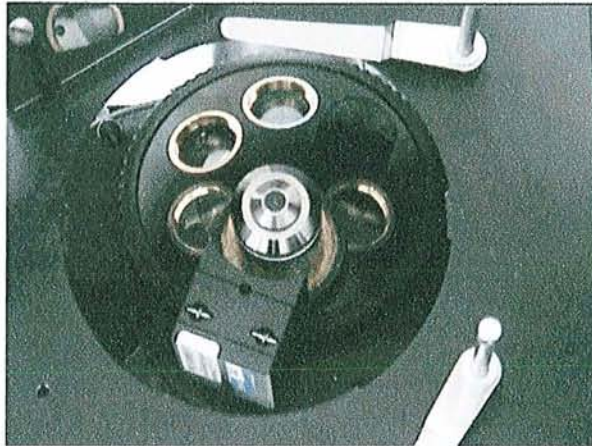
Figure 1 : Système de nanodéplacement piézo monté sur l'objectif 2D par sectionnement optique au point dans l'axe optique).
