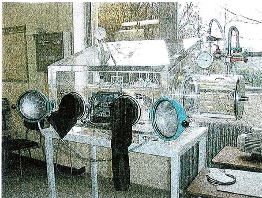
Figure I.14. : Photographie du caisson de pompage utilisé pour cette étude.
