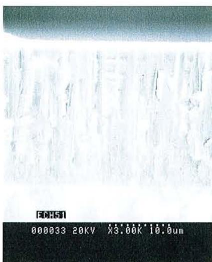
**Figure V.35 :** Section droite du film de diamant déposé sur l'échantillon Dia51.
