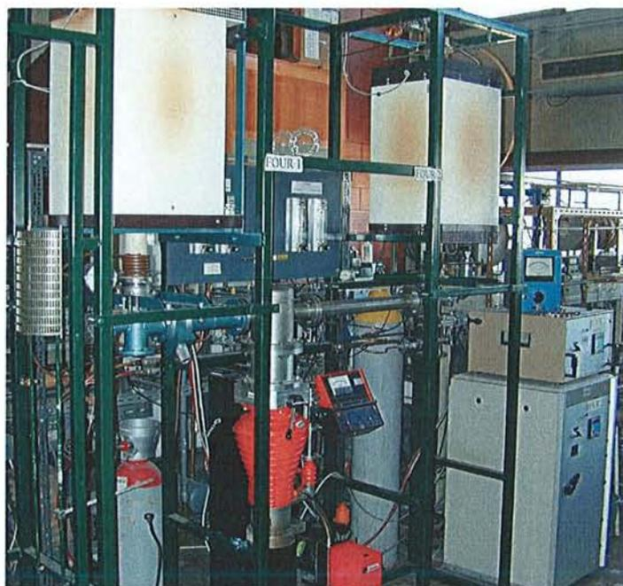
Figure 6 : *Dispositif de traitement thermique des alliages*
