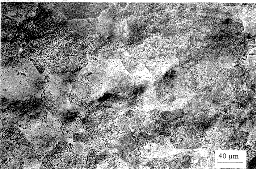
Figure III.7 : Surface de l'alliage Pb- 0,1%Ca- 0,6%Sn a : après 8 heures à température ambiante b : après 30 heures à température ambiante c : après 2,5 ans à température ambiante.
