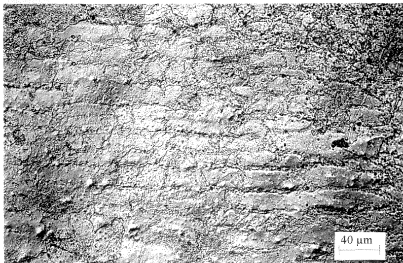
Figure III.21 : Surface des échantillons laminés (80 %) après un vieillissement de 2,5 ans à température ambiante
