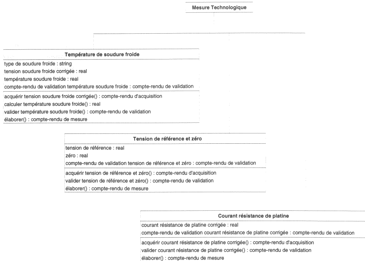
Figure VI.11 : Portion du diagramme d'objet de la hiérarchie de mesure montrant la hiérarchie d'héritage pour la classe "Mesure Technologique".
