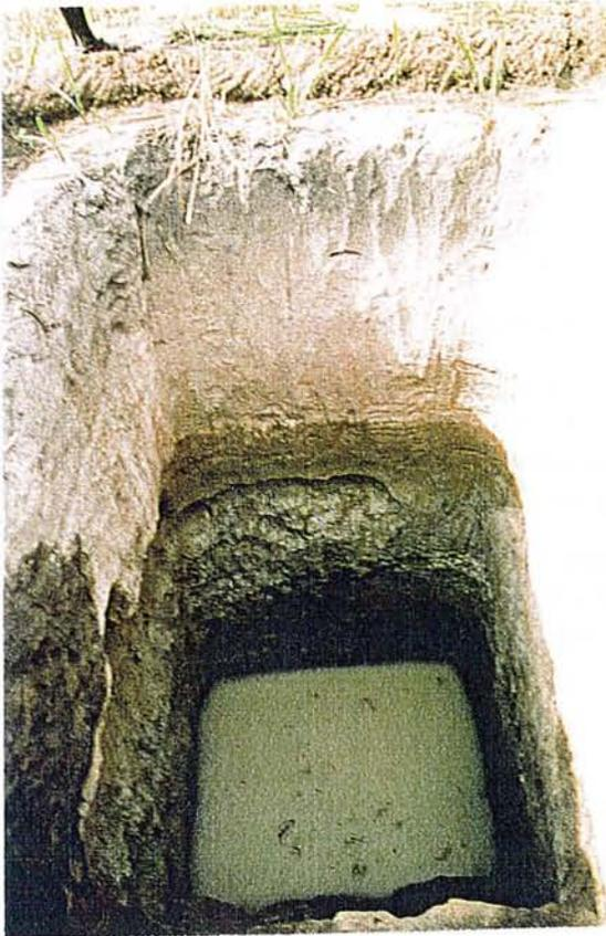
Photo 5 Site B. Infiltration de l'eau de pluie à travers les sols sableux du bas de versant contribuant à l'alimentation et au fonctionnement de la nappe perchée. Les horizons blancs sous l'horizon A1 sont encore secs. Remarquer l'Horizon Vert pistache argileux et compact en dessous des horizons A2 sableux blanchis des sols gris. Entre les deux horizons la cavité a été créée par l'écoulement de la nappe après le creusement de la fosse.
