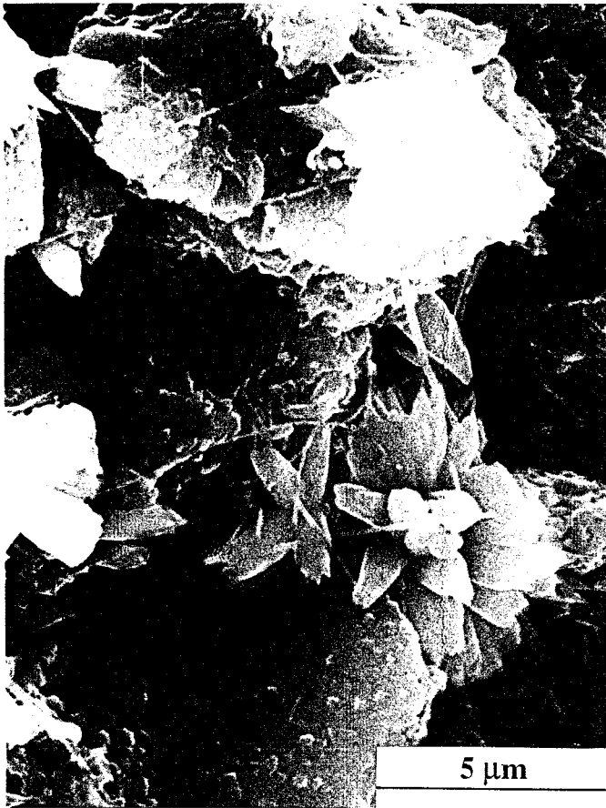
PHOTO N°27 : Carbonatation de l'échantillon ( C_3S-C_3A-15\% \overline{CC} 7 j MH)
