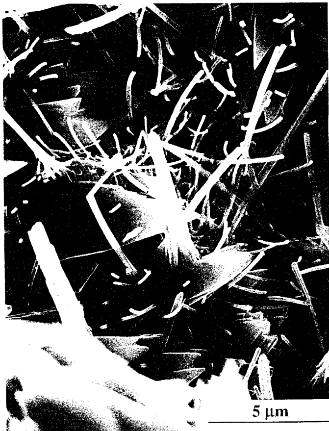
PHOTO N°31 : Affinités chimiques C_6\overline{A}\overline{S}_3H_{32} \overline{C}\overline{C} ( C_3S-C_3A-15\%\overline{C}\overline{C}-5\%\overline{C}\overline{S} 28 j MH)
