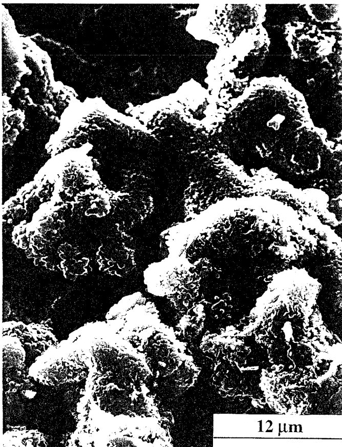
PHOTO N°26 : C_xS_yA_tH_z ( C_3S-C_3A-15\% \overline{CC} 3 j MC)
