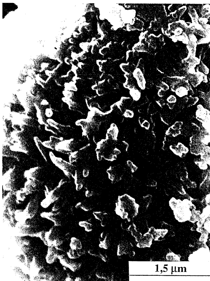
PHOTO N°4 : Filaments de C_xS_yH_z ( C_3S 365 j MC)
