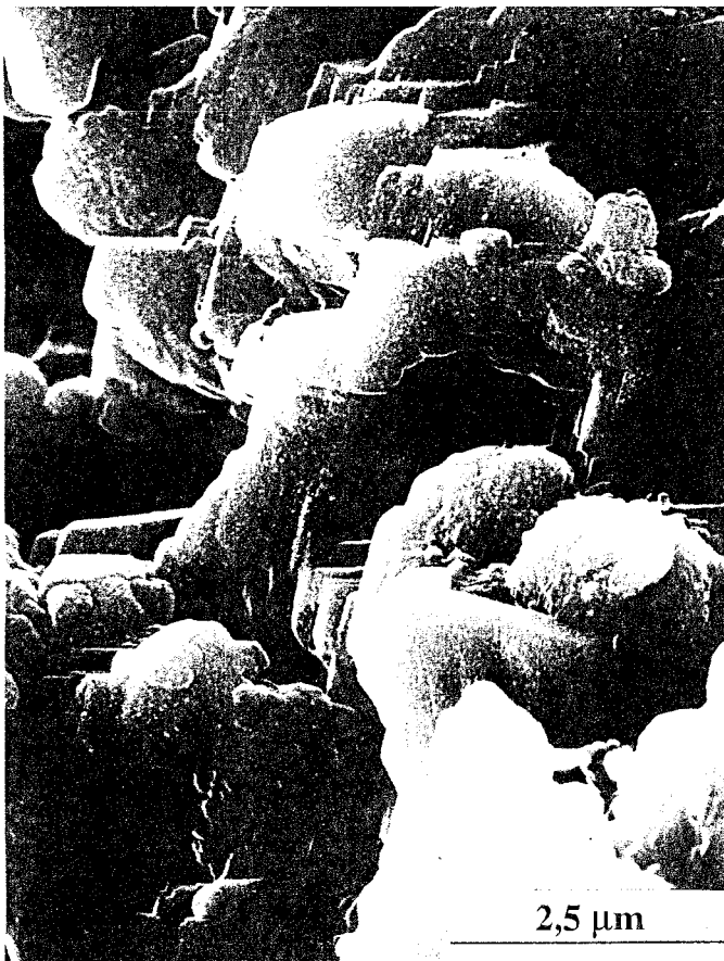
PHOTO N°23 : AH_3 ( C_3A -15% \overline{CC} 365 j MH)
