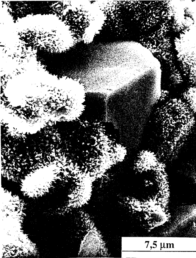
PHOTO N°12 : Interactions C_xS_yH_z-C\bar{C} ( C_3S-15\%C\bar{C} 1 j MH)
