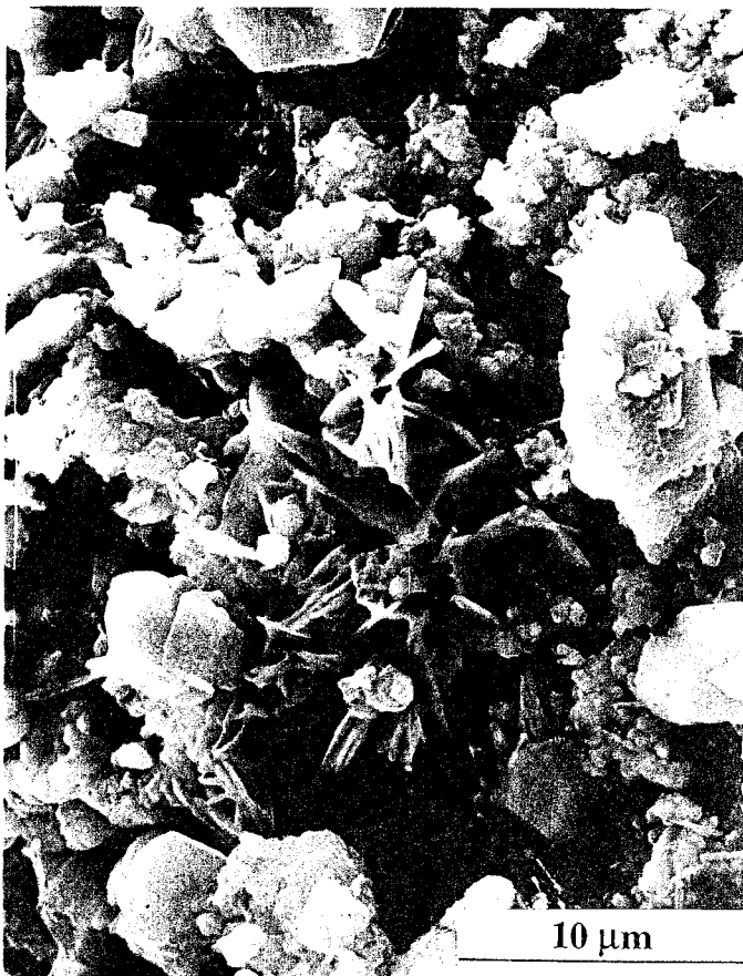
PHOTO N°35 : Carbonatation ( C_3S-C_3A-15\% C\bar{C}-5\% C\bar{S} 180 j MH)
