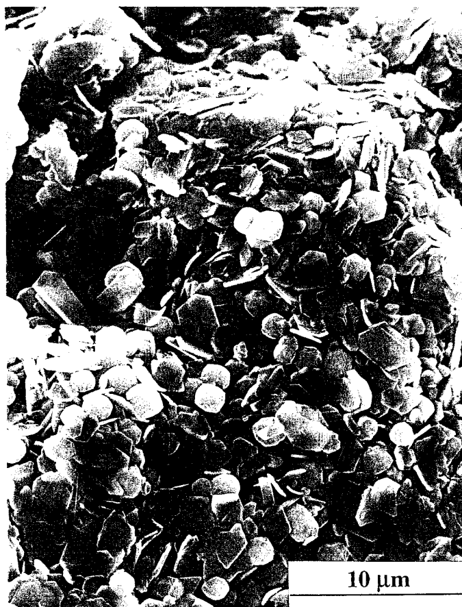
PHOTO N°16 : C_3AH_6 cubique et C_4A\bar{C}H_{11} hexagonal ( C_3A -15% C\bar{C} 7 j MC)
