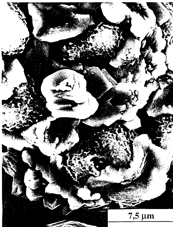
PHOTO N°14 : Carbonation de l'échantillon ( \text{C}_3\text{S} -15% \text{CC} 28 j MH)
