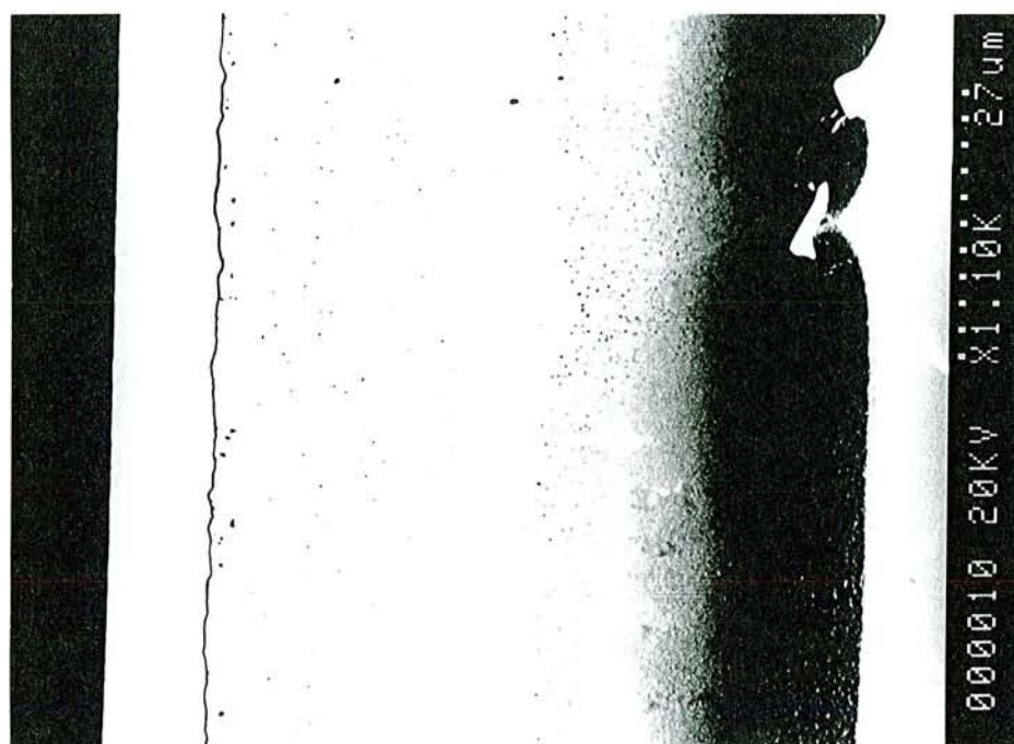
Figure IV-10 : Couche de (\text{Ni}_{1-x}\text{Pd}_x)_2\text{Al}_3 obtenue sur un prédépôt de Pd.
