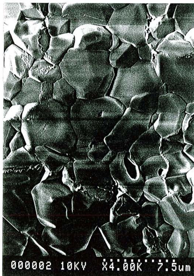
Figure V-19 : Face interne de la couche d'oxyde obtenue après 300 heures d'oxydation sur (Pd 0.6 Ni 0.4 )Al.
