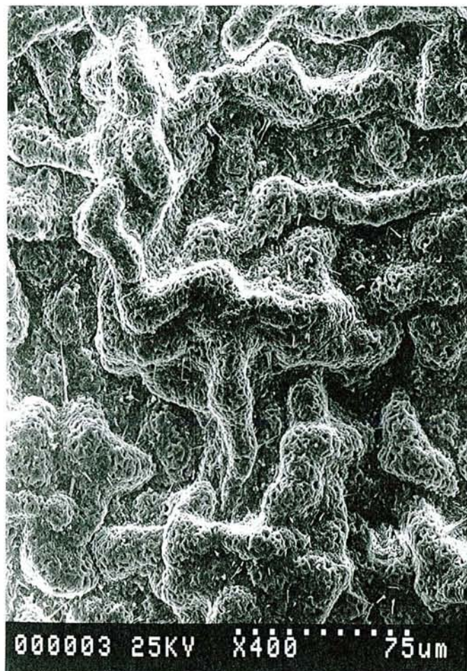
Figure V-14 : (\text{Pd}_{0.6}\text{Ni}_{0.4})\text{Al} oxydé 300h à 1200°C Présences d'importantes circonvolutions
