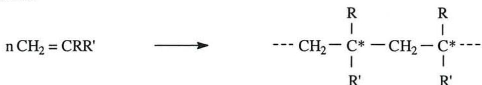
Si on représente le polymère de telle façon que la chaîne carbonée soit dans un plan, les substituants se trouvent de part et d'autre de ce plan à cause de la géométrie spatiale du carbone tétravalent [voir figure 4.1(a) dans le cas du polyméthacrylate de méthyle (PMAM)]. Une autre présentation, plane, couramment utilisée est une projection de Fischer avec les conventions inhabituelles suivantes<sup>6</sup>:
