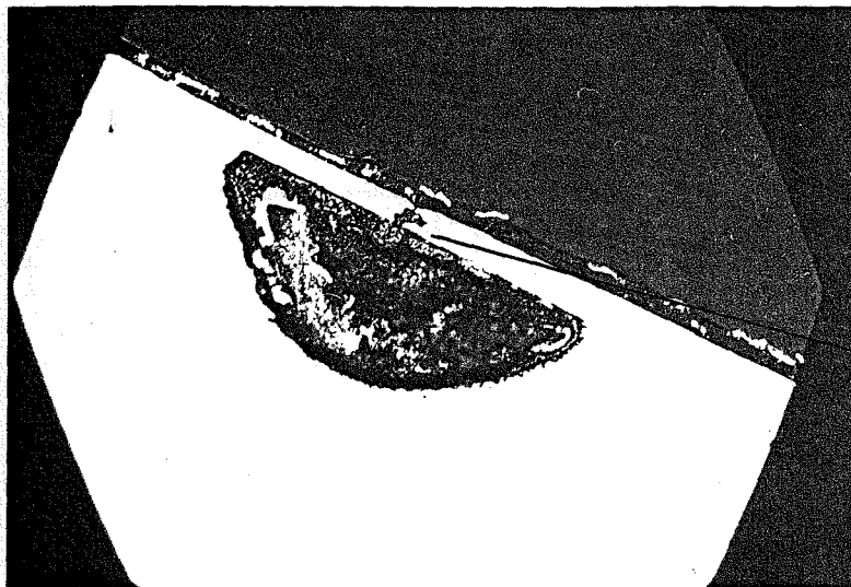
Photo 4 Acier nickelé + EVA 20 jours à 250°C en ampoule scellée x 437 Microscopie optique
