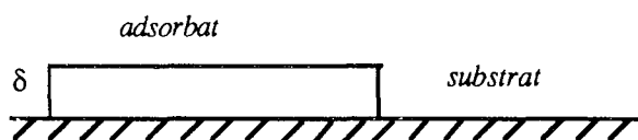
Figure II. 13 : Représentation schématique du dépôt d'un adsorbat sur un substrat
