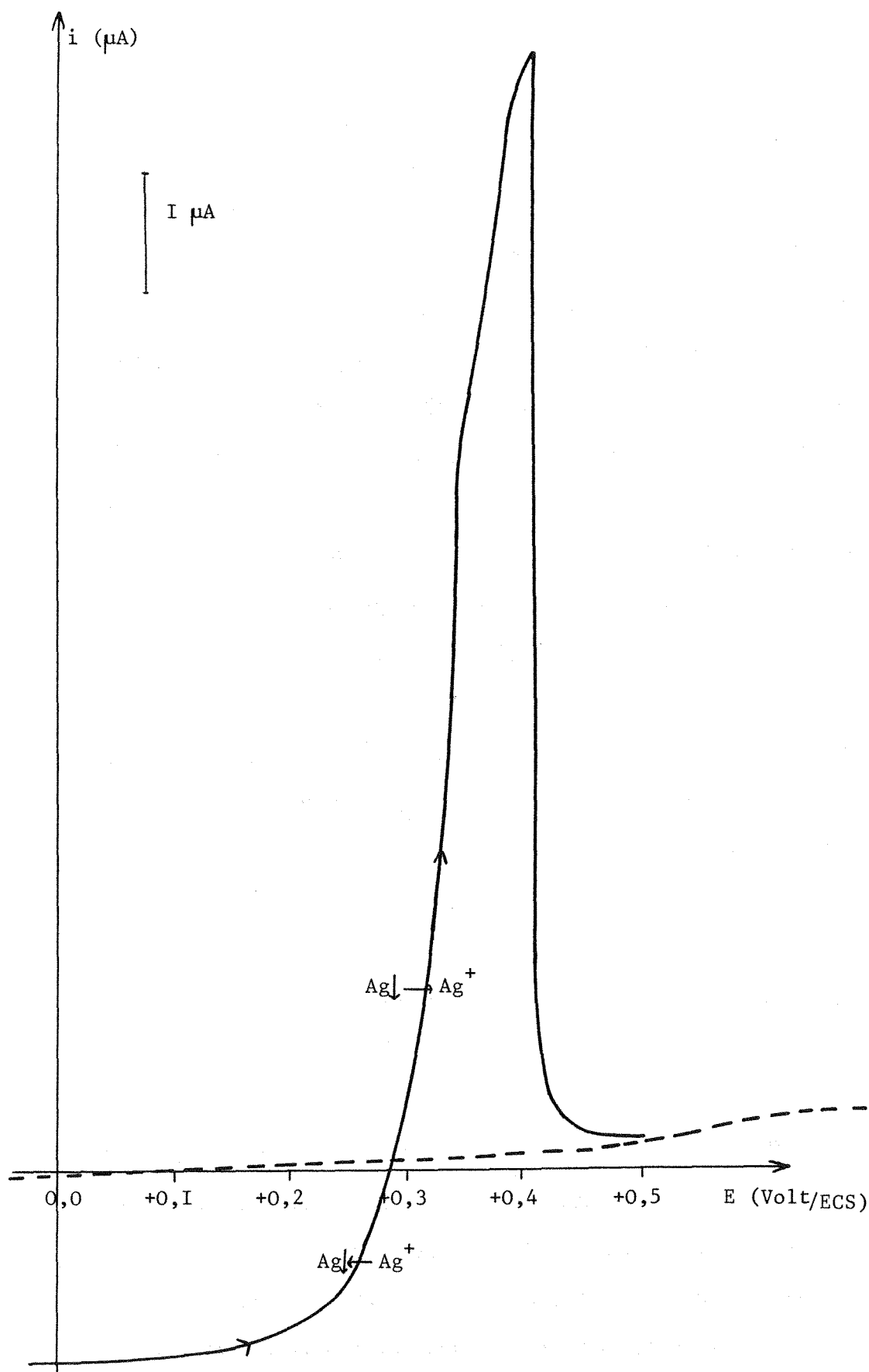
Figure I5: Courbe voltampérométrique à une électrode de Platine dans le milieu R40% ( 37^{\circ}\text{C} , \text{NaClO}_4 0,5 M, \text{AgNO}_3 : 4 \cdot 10^{-4}\text{M} )
