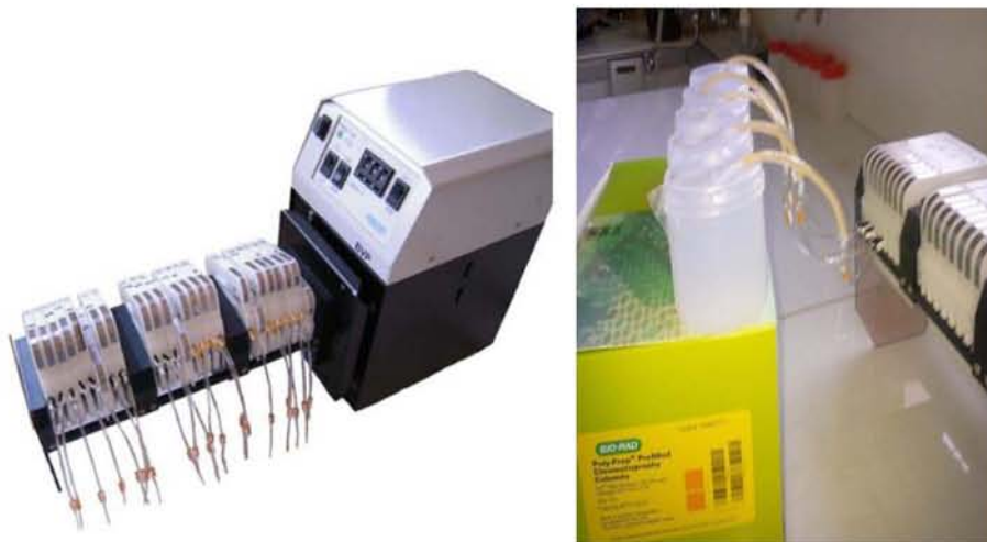
Figure 10 : Montage sur la pompe péristaltique
