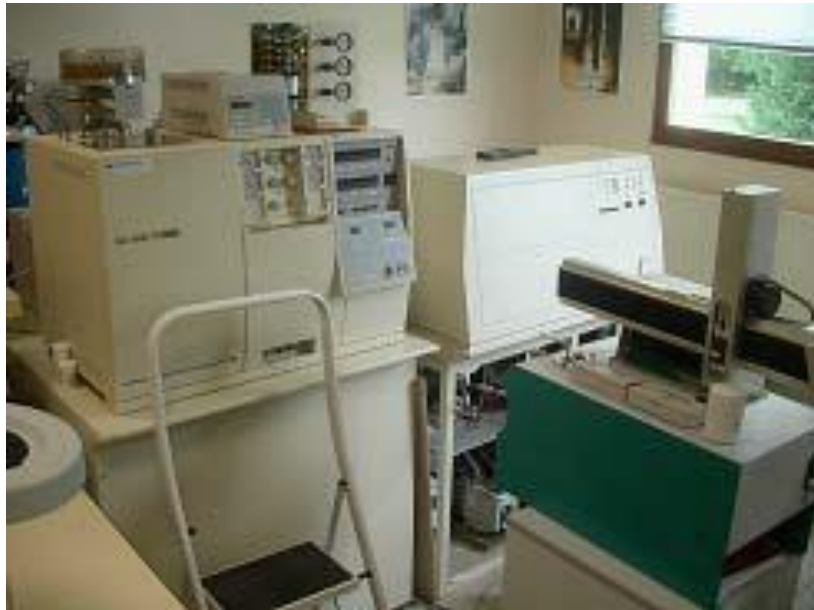
Spectromètre de masse (IRMS) Finnigan, Delta S, pour la détermination de la composition en isotopes stables \delta^{15}\text{N} et \delta^{13}\text{C} couplé avec : - un analyseur élémentaire, CE Instruments, NA 1500 - un Gas Bench II, Finnigan
