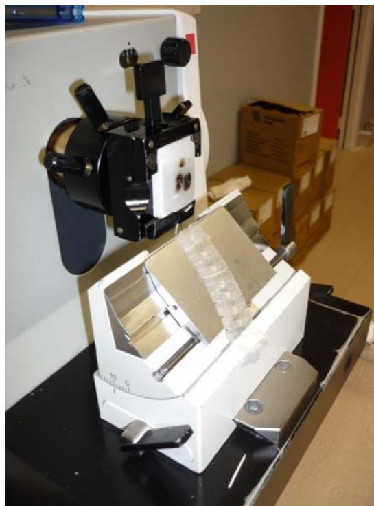
Figure 34: Microtome et ruban de paraffine
