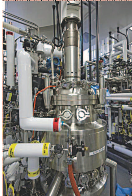
FIGURE 2.4 – Bioréacteur inox de 60 L photographié chez Amgen [?]
