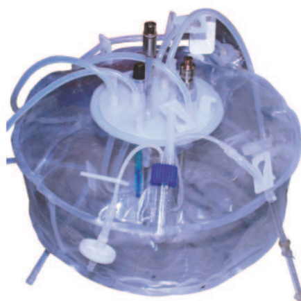
FIGURE 2.11 – Photographie d'un réacteur « à usage unique » de 50L équipé d'une sonde de pH, de température et de pO 2 [?]
