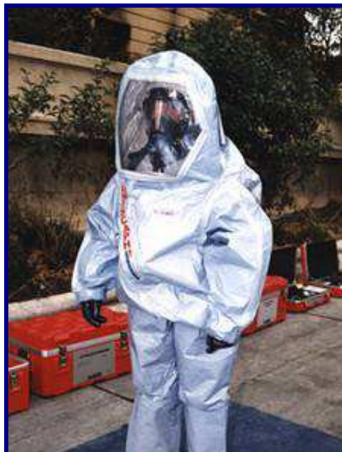
Figure 35 : Scaphandre de protection NRBC avec appareil respiratoire autonome [5].
