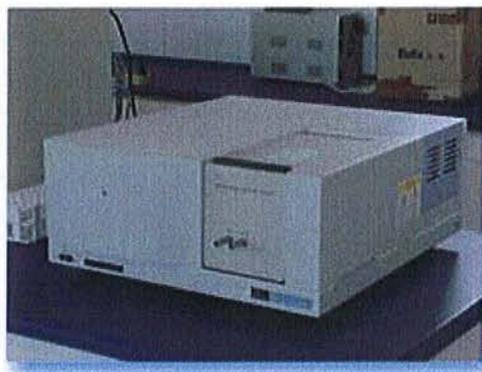
Figure 22 : Spectrophotomètre Lambda EZ 210 Perkin Elmer
