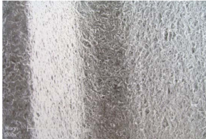
Figure n°10 : Surface obtenue par sablage à l'oxyde de titane observée à faible grossissement (x200) (5)
