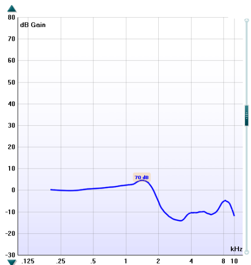
Fig. 48 : Courbe de réponse de l'oreille occluse, cas n°6
