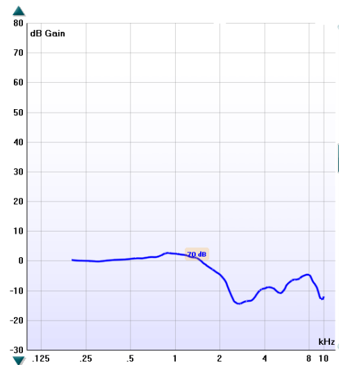
Fig. 46 : Courbe de réponse de l'oreille occluse, cas n°5
