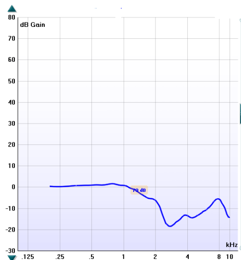
Fig. 44 : Courbe de réponse de l'oreille occluse, cas n°4
