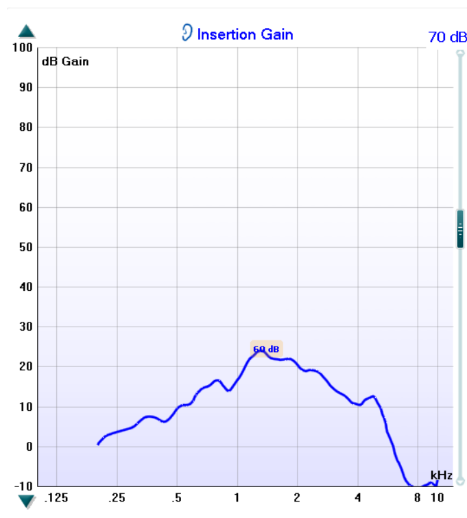
Fig. 56 : Mesure REAR du Fuse
