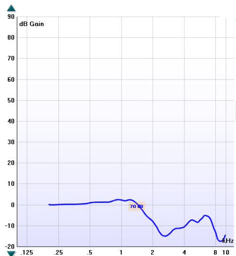
Fig. 52 : Courbe de réponse de l'oreille occluse, cas n°8
