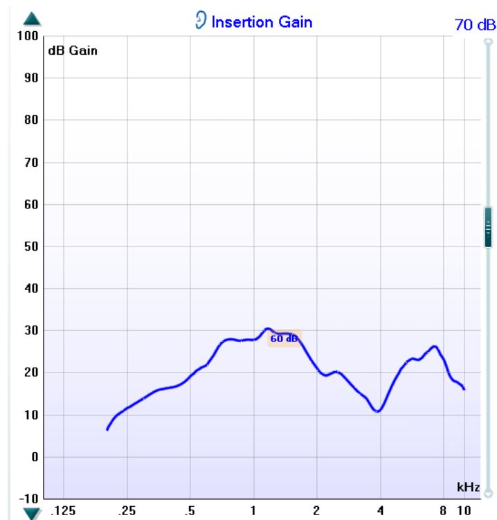
Fig. 58 : Mesure REAR du Moxi
