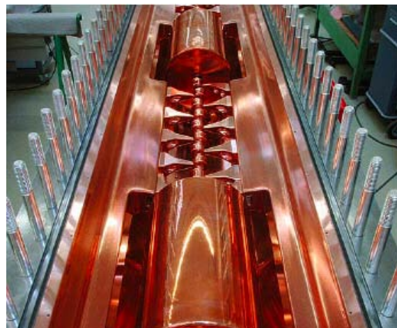
Figure 75 : Accélérateur linéaire injecteur dans le « kit » d'hadronthérapie de Siemens®
