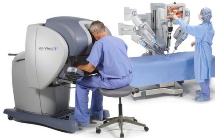
Figure 5 : Système robot maître-esclave Da Vinci® (2ème génération, 4 bras).
