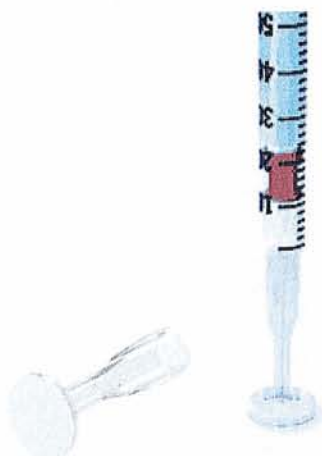
Photographies 1 et 2 : le Stérifilt® (photographie de gauche) ; il s'adapte à la seringue et se place au fond du Stéricup® (photographie de droite)
