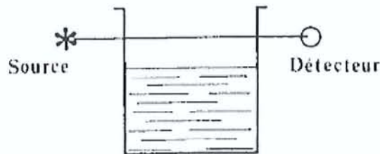
Principe d'une jauge de niveau
