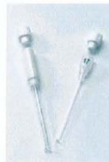
Capillaire en verre borosilicaté de 20 µl et de 100 µl
