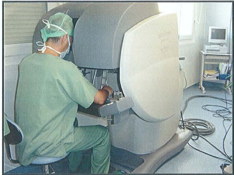
Figure 23 : Chariot mobile portant les bras articulés du robot, sur lesquels se fixent les instruments.
