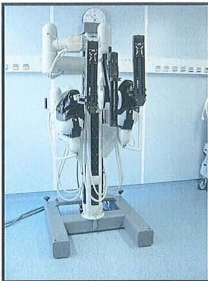
Figure 23 : Chariot mobile portant les bras articulés du robot, sur lesquels se fixent les instruments.
