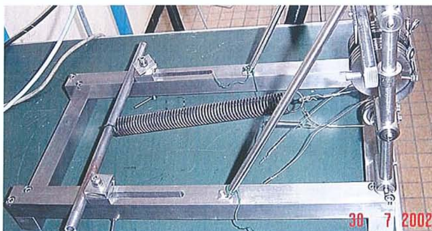
Étalonnage par traction sur un ressort préalablement taré.
