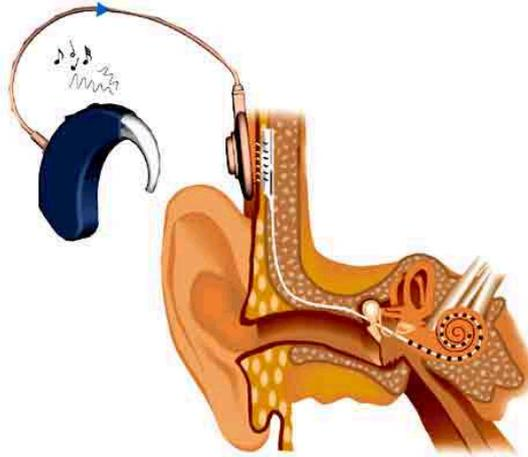
*Figure 3: Schéma de l'implant cochléaire (CISIC, 2011)*
