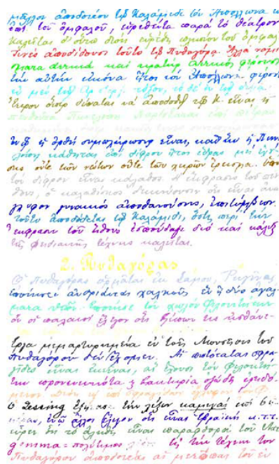
FIGURE 2.12: Exemple d'extraction de lignes sur un document manuscrit Latin (chaque couleur représente une ligne) [Louloudis et al. , 2009a].
