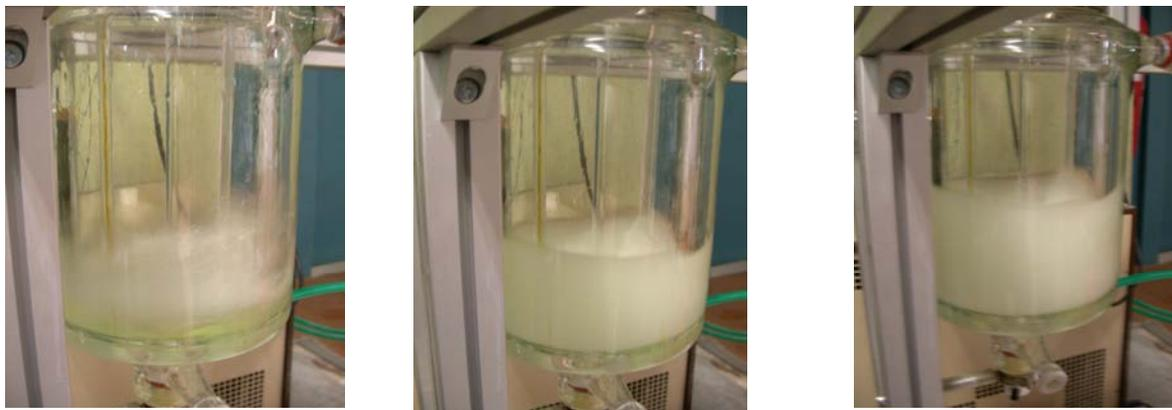
Figure III. 2 : Photos du réacteur au cours d'un essai illustrant la bonne agitation du réacteur (780 tours/min) lors de la coulée. Les photos, de gauche à droite respectivement, ont été prise aux temps  $t=0, 90, 180$  s
