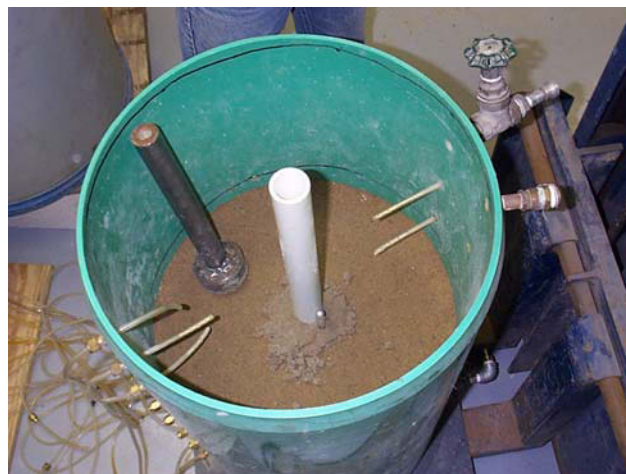
Figure 6.9 : Mise en place locale autour du puits d'un bouchon plus concentré en bentonite pour s'assurer d'éviter des écoulements préférentiels.
