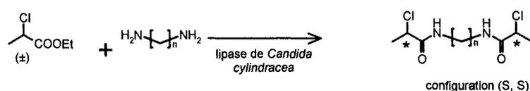
**figure 38 : schéma de la réaction d'amidation.**
