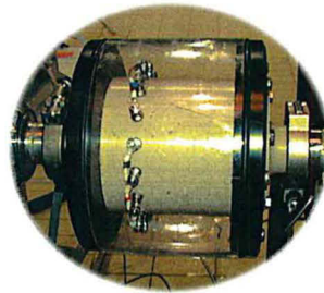
Fig. 3.23 Capteur de tomographie électrique
