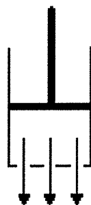
Fig. 1.14 Principe de compression - extrusion
