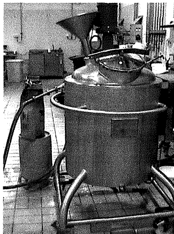
Fig. 2.13 Cuve de poudrage du gel de pectine
