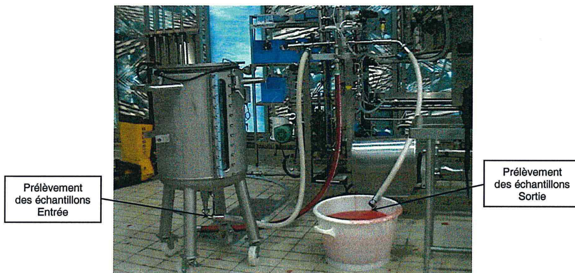
Fig. 3.3 Installation pilote pour l'étude de la pompe doseuse
