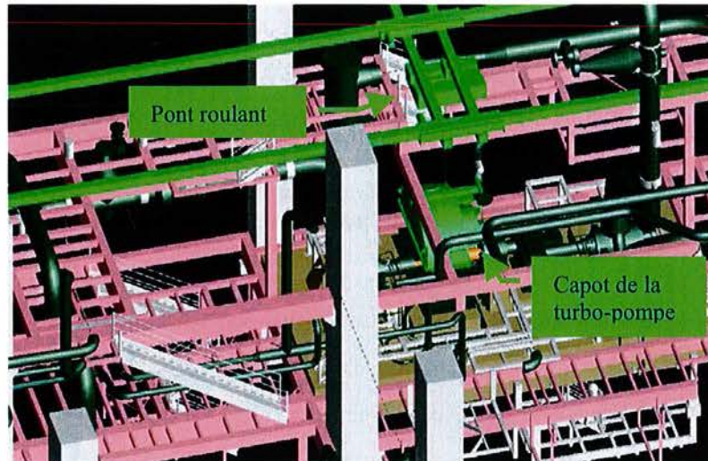
Figure 4.2 – Configuration initiale d'un pont roulant transportant un capot de Turbo-pompe alimentaire « TPA »
