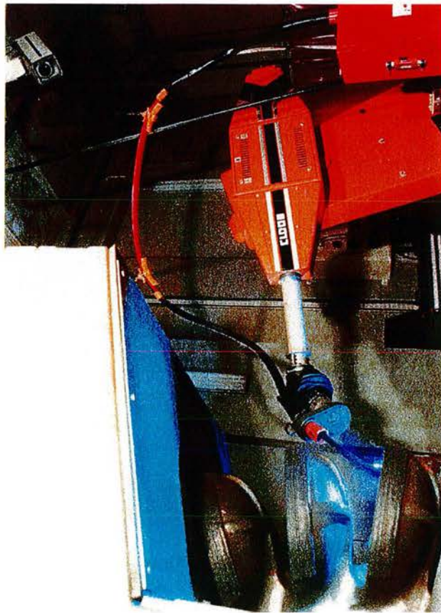
Figure 1.6 : Opération robotisée de ressuage pour la maintenance des augets d'une centrale hydraulique
