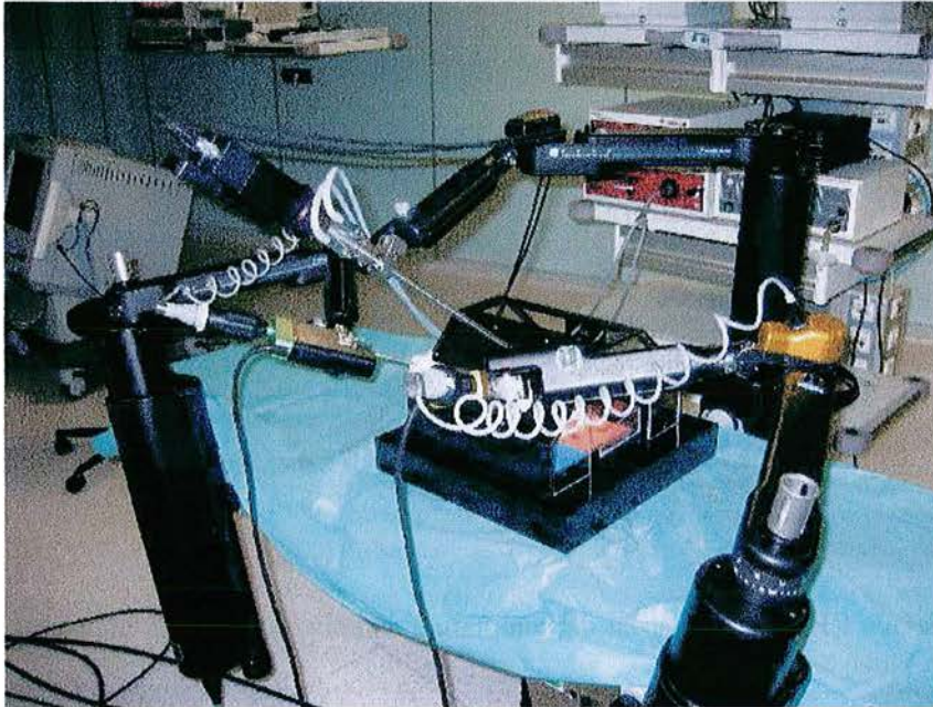
Fig. 1.12: Le système ZEUS : les manipulateurs esclaves
