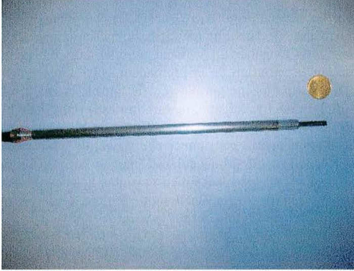
Fig. 2.2: Support à pointage laser
