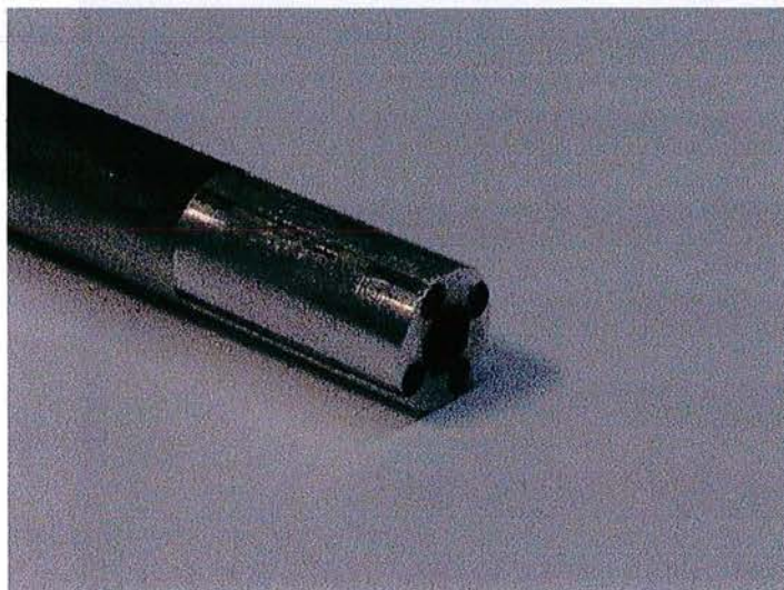
Fig. 2.3: Tête du support à pointage laser
