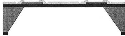
Etape 20 : Attaque chimique de la couche de chrome superficielle afin d'avoir un contact en or.
