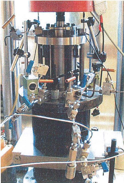
Tous les essais mécaniques ont été réalisés dans la même cellule triaxiale représentée sur la photographie ci-contre (Fig. 4). Il s'agit d'une cellule auto-compensée avec deux chapeaux au choix; l'un autonome pour les essais déviatoriques en force contrôlée et l'autre sans autonomie pour les essais hydrostatiques et les essais déviatoriques en déplacement contrôlé (celui représenté sur la photographie ci-contre).
