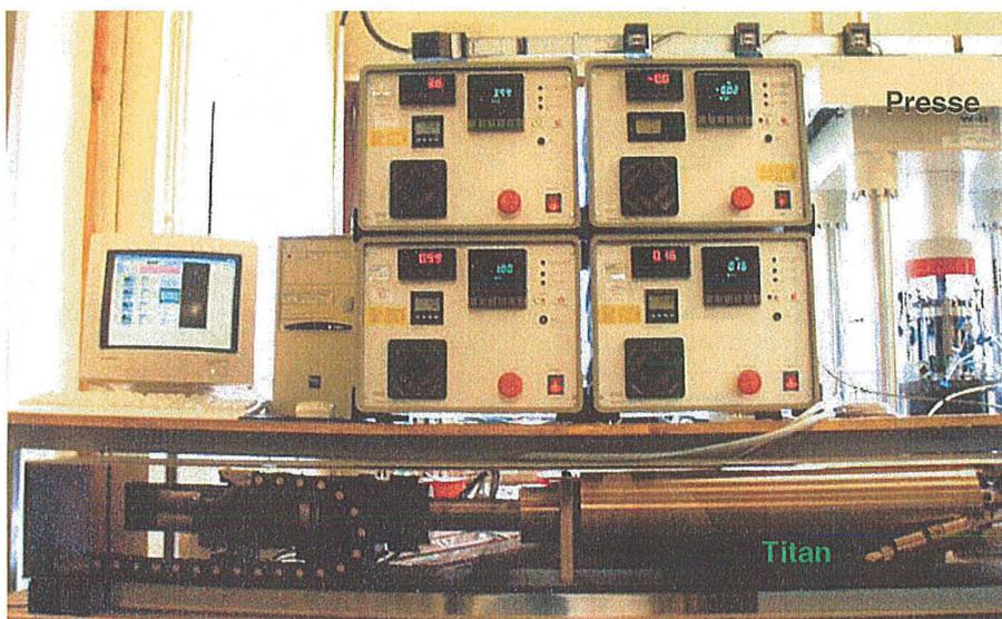
Figure 3 - Système d'asservissement des pressions (générateurs et logiciel).
