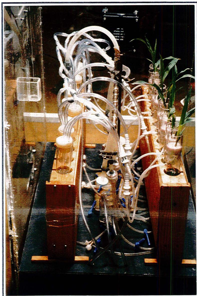
Photographie 2 D . Vue des plantes et des tubes de soude (servant à piéger la respiration racinaire) à l'intérieur de la chambre de marquage
