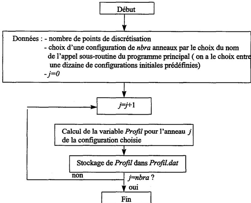
Ce programme calcule donc les *nbra* profils des *nbra* anneaux pour la condition initiale, qui est une expression analytique, et les range dans le fichier *profil.dat*.
