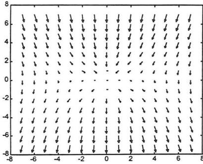
Figure 3.14 Champ  $(\frac{u_{so}^{(1)}}{K^{(0)}}, \frac{v_{so}^{(1)} + v_r^{(1)}}{K^{(0)}})$  dans le plan  $(r^*, \varphi)$  pour  $G=0$
