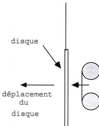
Figure 10 Création d'un anneau par déplacement d'un disque
