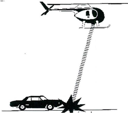
Figure 14 Etouffement du moteur par projection de dioxyde de carbone dans l'air frais qu'utilise le moteur
