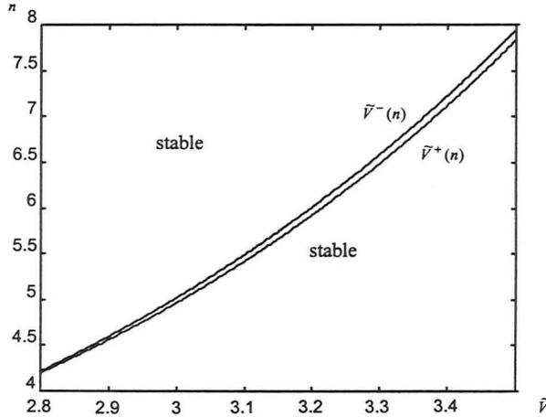
Figure 5.7 Domaines de stabilité et d'instabilité
