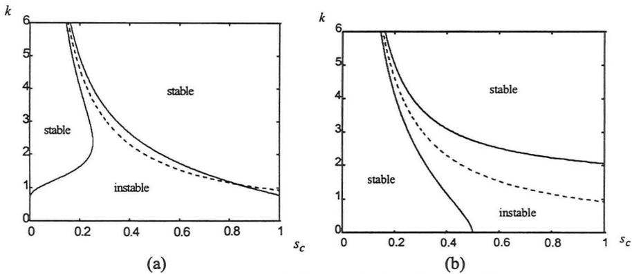
Figure 6.11 Diagramme de stabilité avec la fonction de self induction (6.73a)
