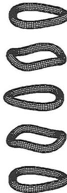
Figure 5.5 : Vue perspective de la simulation numérique d'un mode  $n=3$  (de bas en haut)
