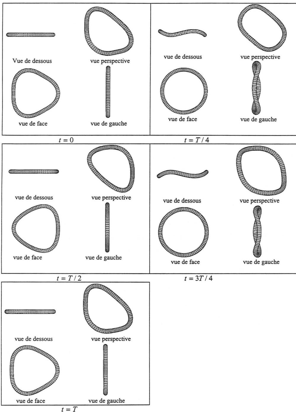
Figure 5.6 Détail de la simulation numérique d'un mode  $n=3$
