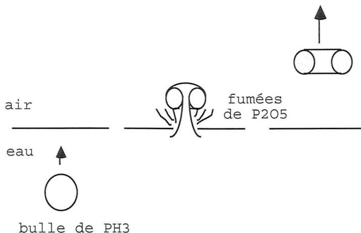
Figure 9 Cr  ation d'un anneau par explosion d'une bulle (vue en coupe)
