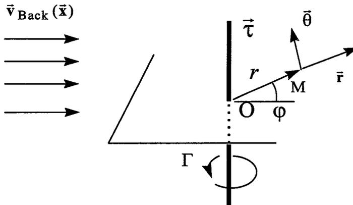
Figure 1.3 : Le filet tourbillon droit dans un écoulement potentiel
