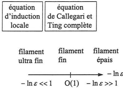
Figure 5.3 Les différents régimes d'épaisseur du filament
