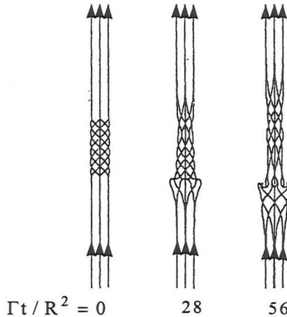
Figure 17 : Simulation numérique d'un éclatement tourbillonnaire par élément de vorticité<sup>28</sup>. Les lignes de vorticité sont représentées à différents temps.
