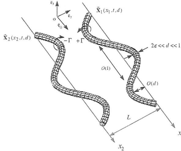
Figure 6.9 Les deux filaments droits parallèles contrarotatifs et leur perturbation
