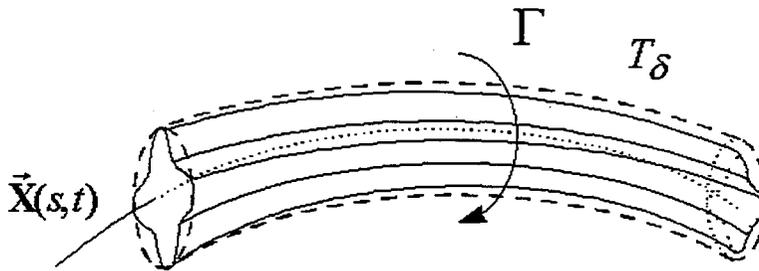
Figure 1.1 : Description d'un morceau de filament tourbillon et du voisinage de sa ligne centrale
