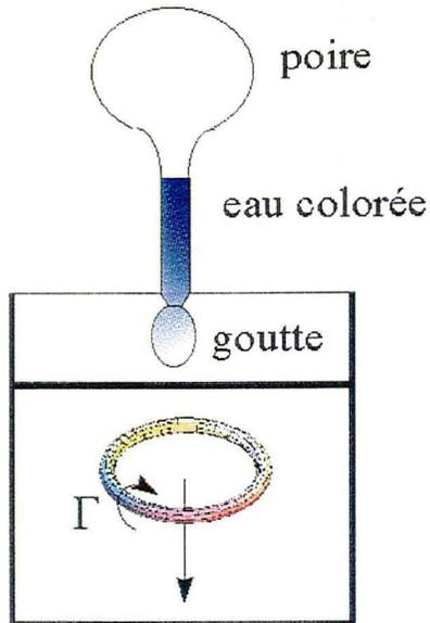
Figure 11 Création d'un anneau par chute d'une goutte
