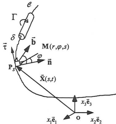
Figure 6.1 La filament tourbillon non fermé
