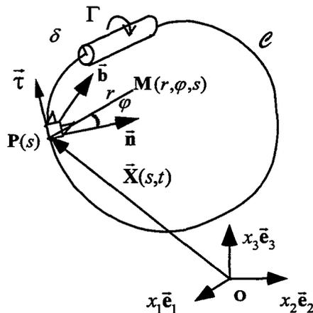
Figure 1.2 : La courbe centrale et les coordonnées locales d'un anneau tourbillon.
