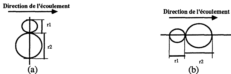
Figure 4.3 : Orientation des particules : (a) à 90^\circ par rapport à l'écoulement (b) dans le sens de l'écoulement.
