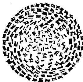
Figure 1.2 : Représentation schématique de la structure interne d'une particule de noir de carbone.
