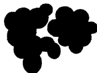
Figure 4.2 : Imbrication de deux particules.
